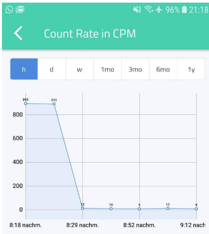
Abb. 6: Zugehörige Messung visualisiert in Cayenne, zu Beginn die Tasse, danach die Nullrate
